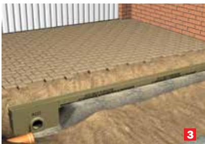
Монтаж начинается с установки пескоуловителя. Каналы устанавливаются в линию по принципу шпунт-паз. Стрелка на каналах указывает направление движения воды (к пескоуловителю).
