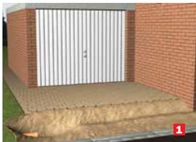
Выкопайте траншею и подведите трубу DN 100 для соединения каналов с ливневой канализацией.
