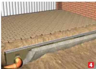
При установке в местах проезда автомобиля первые ряды брусчатки должны быть уложены на то же бетонное основание, что и сам канал!
