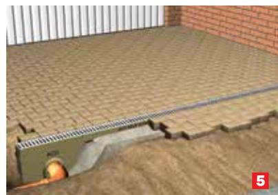
Заполните бетонным раствором анкерные карманы стенок канала и, в зависимости, от высоты мощения выполните укладку на общее бетонное основание таким образом, чтобы вверх решетки был на 3-5 мм ниже уровня мощения. Уложите брусчатку в стык к стенке канала.
