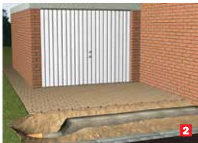
Каналы устанавливаются на основание из бетона марки В15 высотой 15 см и шириной 30 см.
