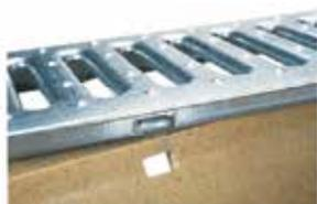
Безболтовое крепление позволяет надежно фиксировать решетку на канале без снижения гидравлических показателей системы. V-образная форма внутри канала увеличивает скорость потока воды, улучшает пропускную способность и самоочищение. Ребра жесткости на стенках канала способствуют его дополнительной прочности.
