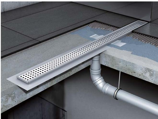
Канал без сифона обеспечивает минимальную монтажную высоту и позволяет вывести канализационную трубу в помещение снизу. Сифон должен быть выполнен изгибом трубы. Инструкция по монтажу на стр. 35
