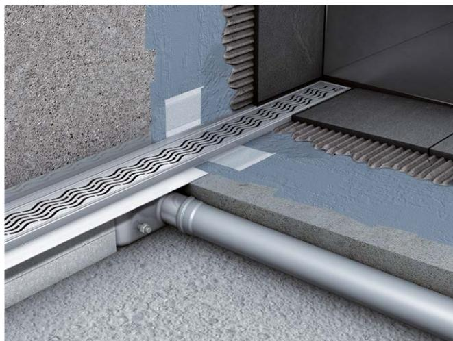
Канал с вертикальным фланцем используется для монтажа канала у стены. Фланец позволяет выполнить наиболее надежную гидроизоляцию. Инструкция по монтажу на стр. 35
