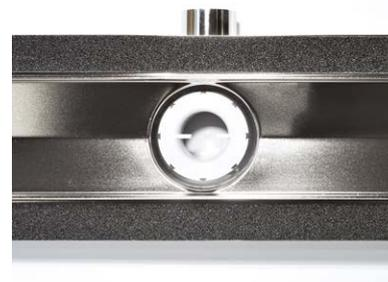
Внутри канал имеет уклон для лучшей пропускной способности. Извлекаемый разборный сифон с гидрозатвором обеспечивает надежную защиту от запахов, простое обслуживание и доступ к канализационной трубе.
