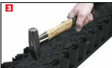
Для варианта с вертикальным отводом из линии каналов в нужном месте выбейте специально отформованное отверстие под трубу DN 100.
