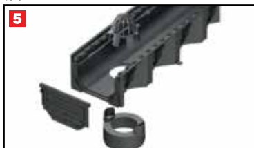
Вставьте патрубок и корзину для улавливания листьев в выбитое отверстие для вертикального отвода. При необходимости присоедините торцевую заглушку.
