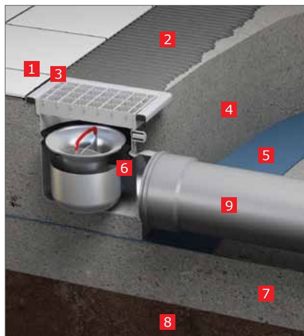
Монтаж однокорпусного трапа в черновую стяжку пола
