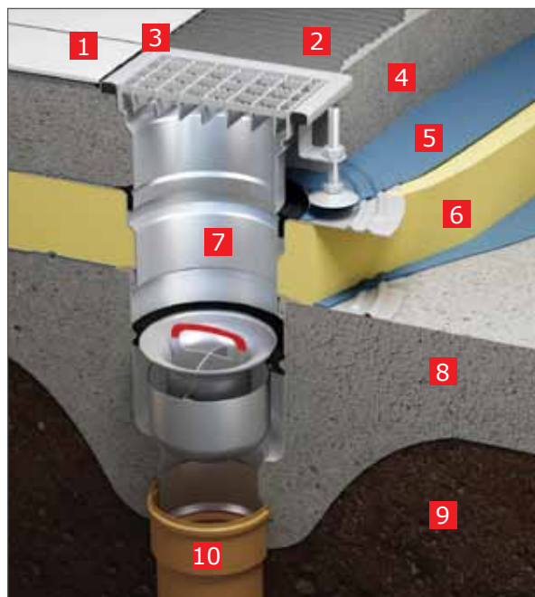
Монтаж двухкорпусного трапа со вставкой в черновую стяжку пола
